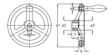
b = 34 d1 = 500 d2 H7 = 34 d3 = 78 d4 = M 12 Handle  $\overline{\phantom{0}}$  = 32 l1 = 45 l2 = 72
